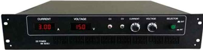
본 기기는 SMPS 방식으로 대용량 출력에 비해 소형으로 제작되었으며 RACK에 장착 될 수 있게 2U SIZE 19"형 RACK에 설치 할 수 있도록 설계되었습니다. 정전압과 정전류 모드로 사용 가능하며,수처리 장치의(EDI SYSTEM)의 초순수 제조기의 전원으로 사용시 이온수지를 보호 합니다.
